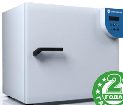
**Шкаф сушильный DION SIBLAB** предназначен для сушки, нагревания, термической обработки различных материалов и изделий в воздушной среде. Стабильность температуры в установленном режиме  $\pm 1^\circ\text{C}$ . Неравномерность температуры в объеме рабочего пространства не более  $\pm 2^\circ\text{C}$ .
