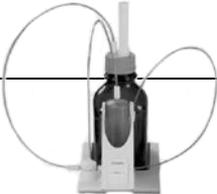
Сменный бюреточный модуль WA 10/20/50 мл со встроенным микрочипом для записи данных используемого реагента, бутылку темного стекла с адаптером GL45 объемом 1л и адаптером S40, трубками, капельной трубкой и аксессуарами |
